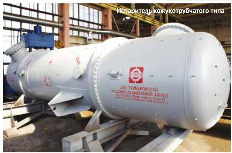
Испаритель кожухотрубчатого типа
